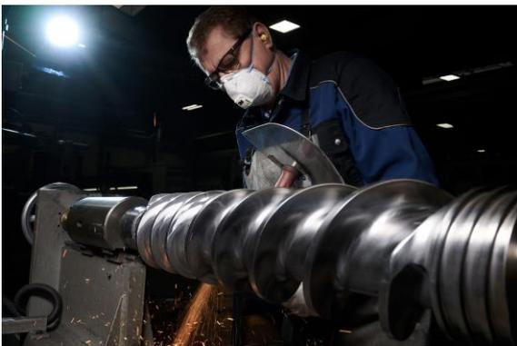
*Fertigung einer Extruderschnecke bei 3S. Das gruppeneigene Komponentenfertigungsunternehmen erhöht durch gezielte Investitionen den Eigenfertigungsanteil zentraler Bauteile.*
