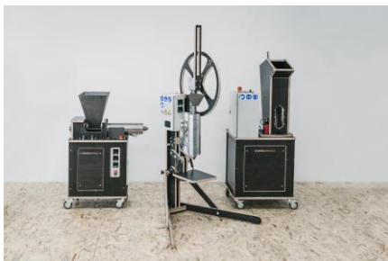
Shredder, Spritzgießeinheit und Extruder. (Foto: plasticpreneur)
